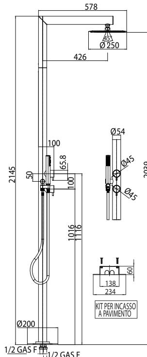
Colonna doccia NEK da esterno in acciaio INOX AISI 316, con alimentazione acqua a terra. Colonna doccia completa di: Kit di fissaggio a pavimento per il collegamento all'impianto idraulico (calda e fredda) - 2 rubinetti miscelatori – Soffione Twiggy - Doccia Zen c/supporto
