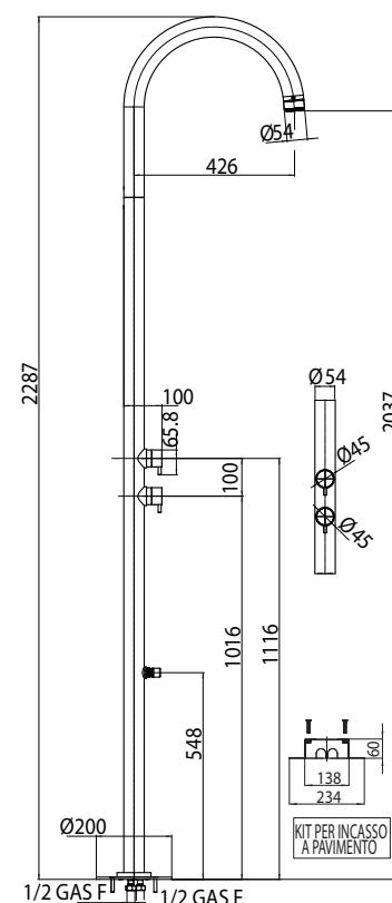
Colonna doccia Pool da esterno in acciaio INOX AISI 316, con alimentazione acqua a terra. Colonna doccia completa di: Kit di fissaggio a pavimento per il collegamento all'impianto idraulico (calda e fredda) - 2 rubinetti miscelatori - Soffione Pool - Diffusore lavapiedi
