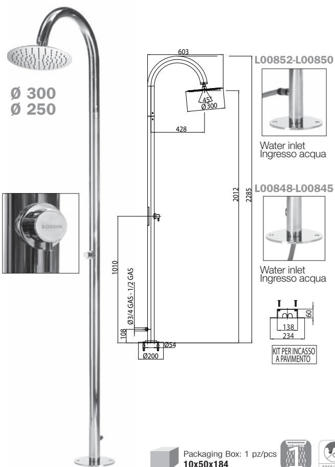
Colonna doccia Twigg Column da esterno in acciaio INOX AISI 316. Con rubinetto d'arresto, con attacco 3/4" M per alimentazione acqua esterna
