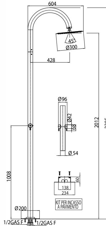
Colonna doccia Twiggy Column da esterno in acciaio INOX AISI 316. Rubinetto con alimentazione acqua a terra, calda e fredda
