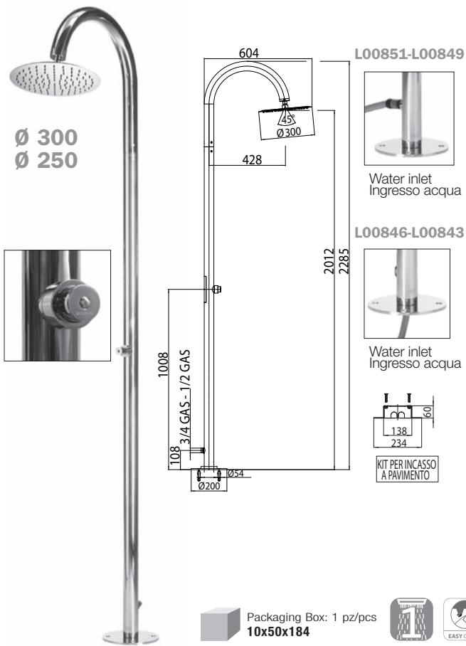
Colonna doccia Twigg Column da esterno in acciaio INOX AISI 316. Con rubinetto a tempo, con attacco 3/4" M per alimentazione acqua esterna
