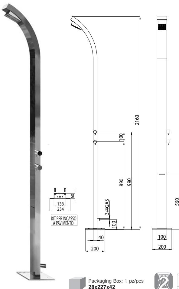
**Colonna doccia Arch-Renovation** da esterno in acciaio INOX AISI 316, con alimentazione dell'acqua esterna. Colonna doccia completa di:
