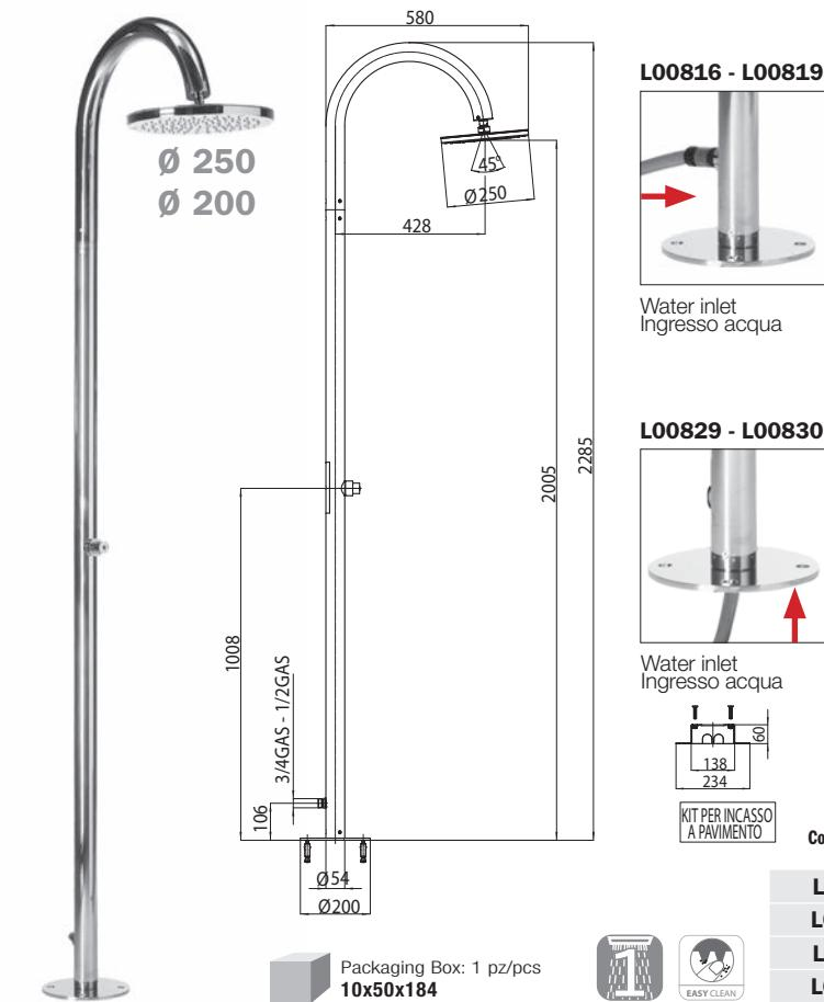
Colonna doccia OKI Column da esterno in acciaio INOX AISI 316. Con rubinetto a tempo, con attacco 3/4" M per alimentazione acqua esterna
