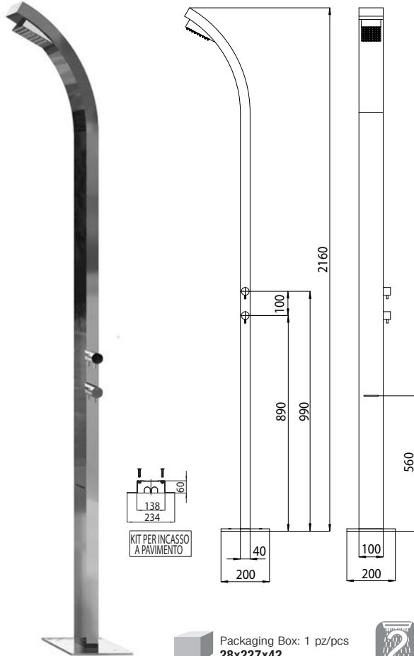
**Colonna doccia Arch Column** da esterno in acciaio INOX AISI 316, con alimentazione acqua a terra. Colonna doccia completa di:
