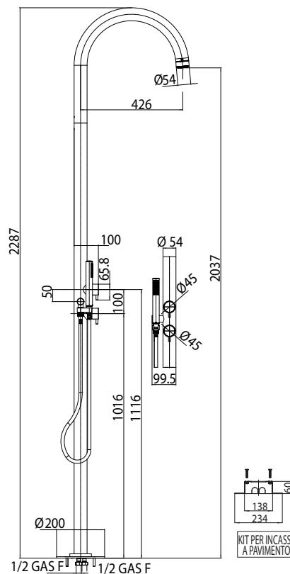
Colonna doccia Pool da esterno in acciaio INOX AISI 316, con alimentazione acqua a terra. Colonna doccia completa di: Kit di fissaggio a pavimento per il collegamento all'impianto idraulico (calda e fredda) - 2 rubinetti miscelatori - Soffione Pool - Doccia Zen c/supporto
