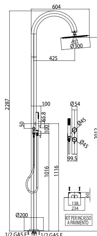
Colonna doccia Twiggy da esterno in acciaio INOX AISI 316, con alimentazione acqua a terra. Colonna doccia completa di: Kit di fissaggio a pavimento per il collegamento all'impianto idraulico (calda e fredda) - 2 rubinetti miscelatori – Soffione Twiggy - Doccia Zen c/supporto
