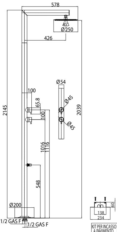
Colonna doccia NEK da esterno in acciaio INOX AISI 316, con alimentazione acqua a terra. Colonna doccia completa di: Kit di fissaggio a pavimento per il collegamento all'impianto idraulico (calda e fredda) - 2 rubinetti miscelatori – Soffione Twiggy - Diffusore lavapièdi
