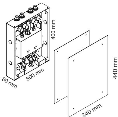
Miscelatore termostatico elettronico con 4 uscite e funzione luci (Led Light o Led RGB cromoterapia). Il kit di installazione è fornito completo del Miscelatore termostatico con elettrovalvole, tastiera digitale con le corrispondenti scatole di contenimento a muro e trasformatore di corrente
