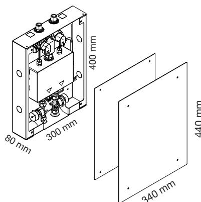
Miscelatore termostatico elettronico con 2 uscite.
