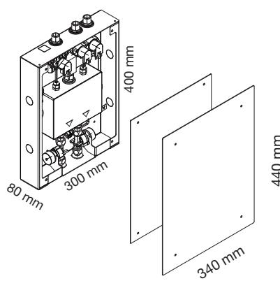
Miscelatore termostatico elettronico con 3 uscite.
